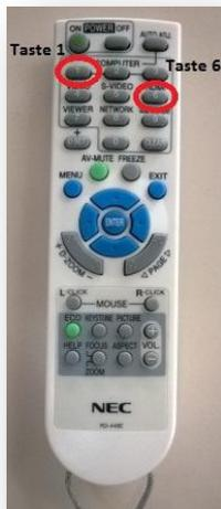
Sicherstellen, dass der zusätzliche Beamer auf VGA Eingang geschaltet ist (Taste „1“)
