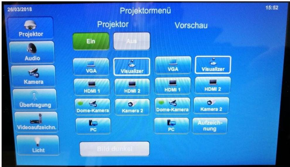
Im „Beamer-Menü“ kann der Beamer manuell ein- bzw. ausgeschaltet werden.
