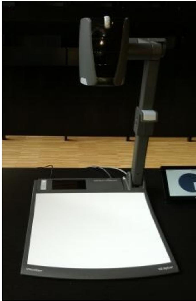
Die Dokumentenkamera wurde als Ersatz für den Overheadprojektor in die Hörsaaltechnik integriert. Mit dem Gerät besteht die Möglichkeit, Gegenstände zu erfassen und auf dem Projektor darzustellen. Natürlich können auch Folien präsentiert werden.
