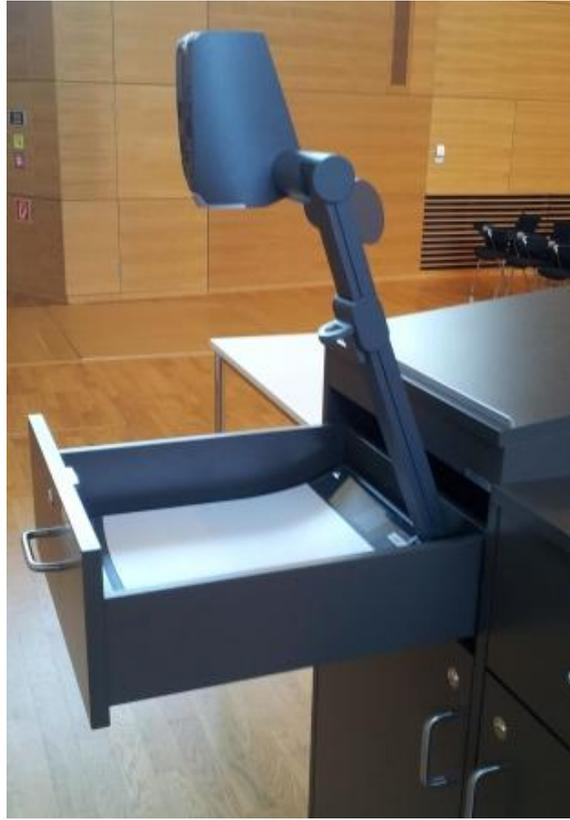
Die Dokumentenkamera wurde als Ersatz für den Overheadprojektor in die Hörsaaltechnik integriert. Mit dem Gerät besteht die Möglichkeit Gegenstände zu erfassen und auf dem Projektor darzustellen. Natürlich können auch Folien präsentiert werden.
