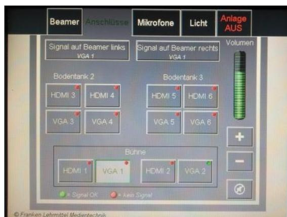
Hier können die Beamer ein- und ausgeschaltet werden. Unter der Registerkarte „Anschlüsse“ besteht die Möglichkeit, die einzelnen Medienanschlüsse am Pult auf die Beamer zu schalten.
