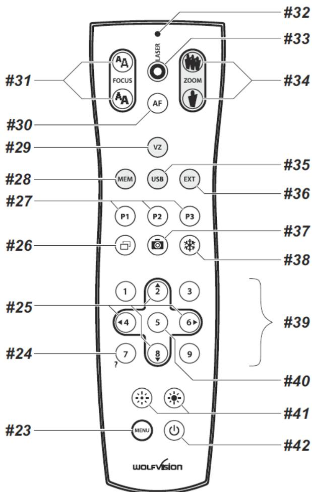
Zum **Wiedergeben** von gespeicherten Bildern (JPEG-Format) muss zunächst über die Fernbedienung mit der Taste „USB“ (#35) der Bildspeicher ausgewählt werden.
