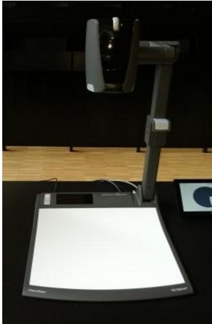
Die Dokumentenkamera wurde als Ersatz für den Overheadprojektor in die Hörsaaltechnik integriert. Mit dem Gerät besteht die Möglichkeit, Gegenstände zu erfassen und auf dem Projektor darzustellen. Natürlich können auch Folien präsentiert werden.
