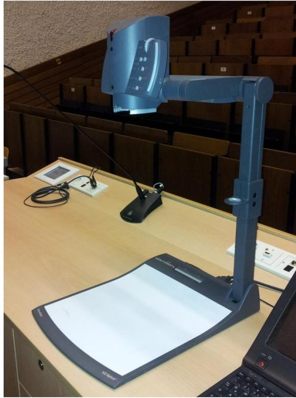
Die Dokumentenkamera wurde als Ersatz für den Overheadprojektor in die Hörsaaltechnik integriert. Mit dem Gerät besteht die Möglichkeit, Gegenstände zu erfassen und auf dem Projektor darzustellen. Natürlich können auch Folien präsentiert werden.
