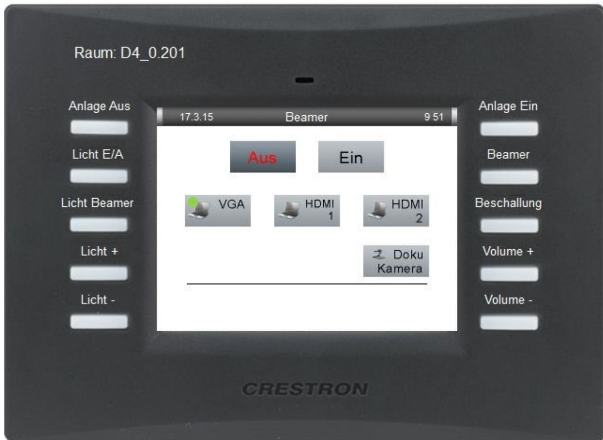
Im „Beamer-Menü kann der Beamer manuell ein- bzw. ausgeschaltet werden.
