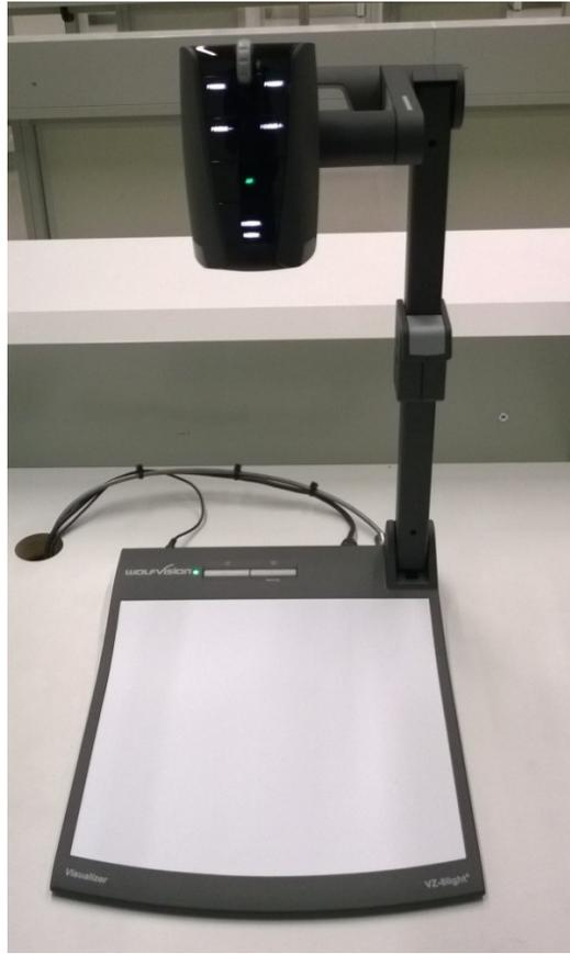
Die Dokumentenkamera wurde als Ersatz für den Overheadprojektor in die Hörsaaltechnik integriert. Mit dem Gerät besteht die Möglichkeit, Gegenstände zu erfassen und auf dem Projektor darzustellen. Natürlich können auch Folien präsentiert werden.
