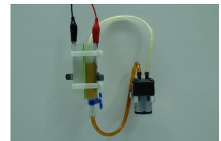
Abbildung 9: Hybride Zink-Iod-Redox-Flow-Batterie
