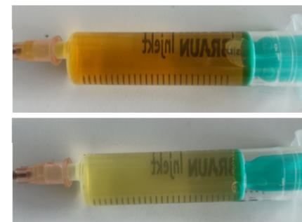
Abbildung 10: oben: (kurz) geladener Elektrolyt, unten: teilweise entladener Elektrolyt
