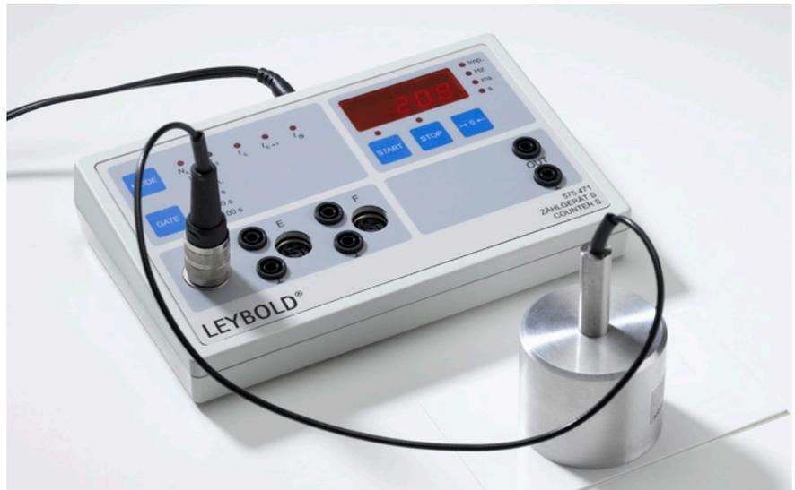
Messung der Zählrate der aufgefangenen Radionuklide auf der Kunststoffplatte
